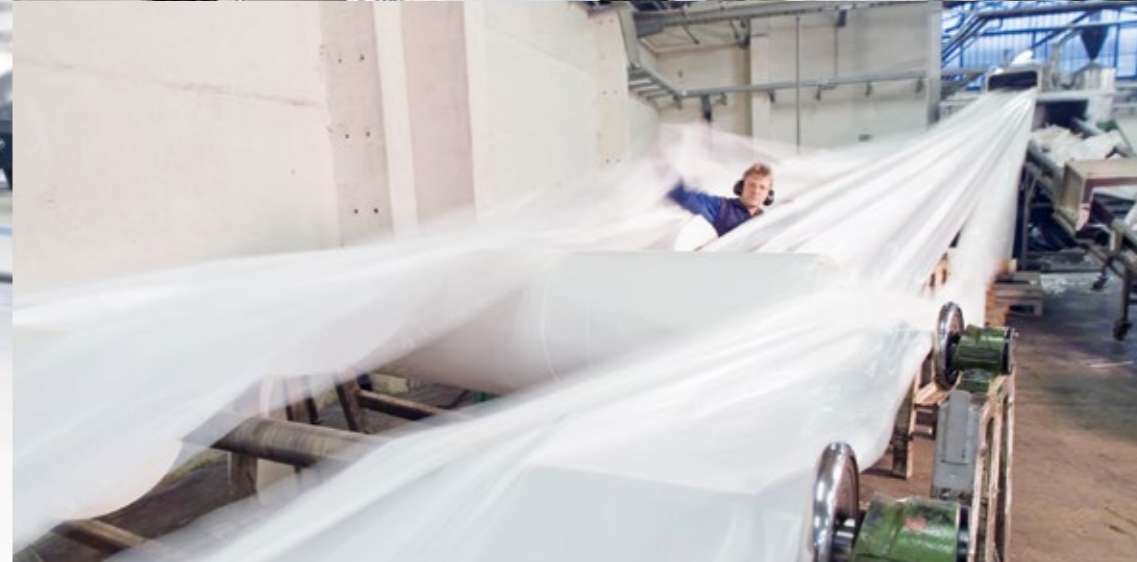
Links oben: Jede der 70 Extrusionsanlagen bei Polifilm wird pro Tag mehrmals umgestellt, die Abfälle werden sorten- und farbrein gesammelt, bevor sie einer Recyclinglinie zugeführt werden; Rechts oben: Für die Herstellung von Müllsäcken werden 100 % Regranulate aus den eigenen Recyclinglinien eingesetzt; Links unten: Bei einer Produktionskapazität von 220.000 jato Folien fallen Umstell- und Anfahrreste an – hier lohnt sich der Einsatz eigener Recyclinglinien; Rechts unten: Reinhard Händel: „Wir realisieren mit unseren eigenen Recyclinganlagen nicht nur die abfallfreie Fabrik, sondern arbeiten auch sehr ökonomisch.“
