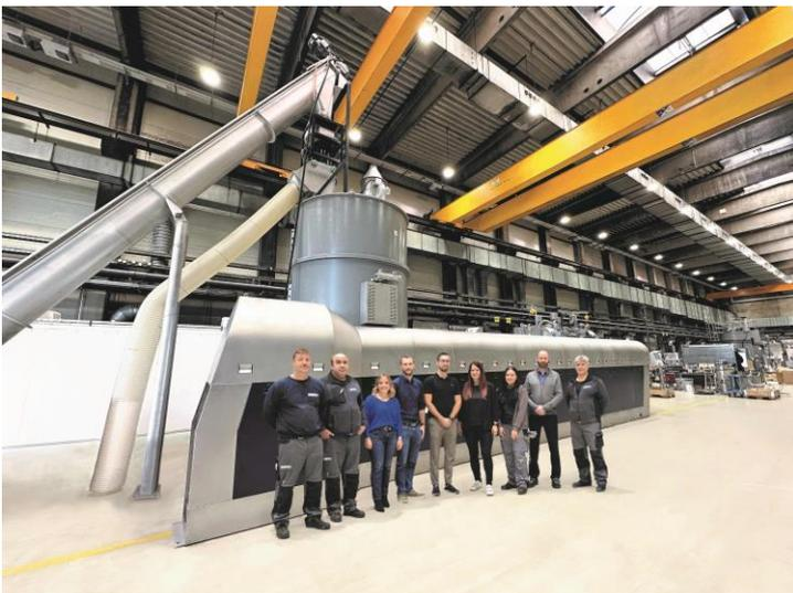
Die INTAREMA® 2325 T-VEplus® Re grindPro® ist die größte jemals gebaute Maschine für PO-Mahlgut und erreicht einen Durchsatz von über 4 Tonnen pro Stunde. Am Bild das EREMA Projektteam vor der neuen Anlage.
